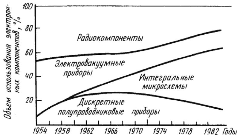
Рис. 1. Использование радиоэлектронных элементов в аппаратуре
