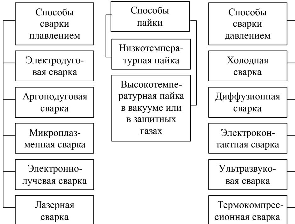
Рис. 25. Основные способы сварки и пайки, используемые при сборке электронных приборов
