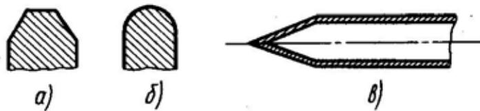
Рис. 113. Плоская (а) и цилиндрическая (б) формы пуансонов для пережима штенгелей и металлический штенгель после холодной заварки (в)
