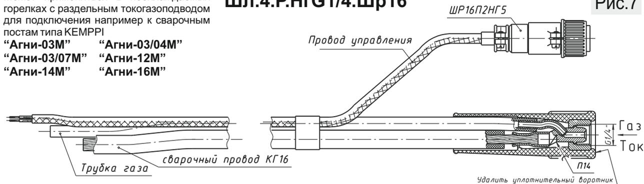
Может применяться в не охлаждаемых горелках с раздельным токогазоподводом для подключения например к сборным сварочным постам
