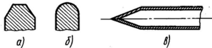
Рис. 113. Плоская (а) и цилиндрическая (б) формы пуансонов для пережима штангелей и металлический штангель после холодной заварки (в)
