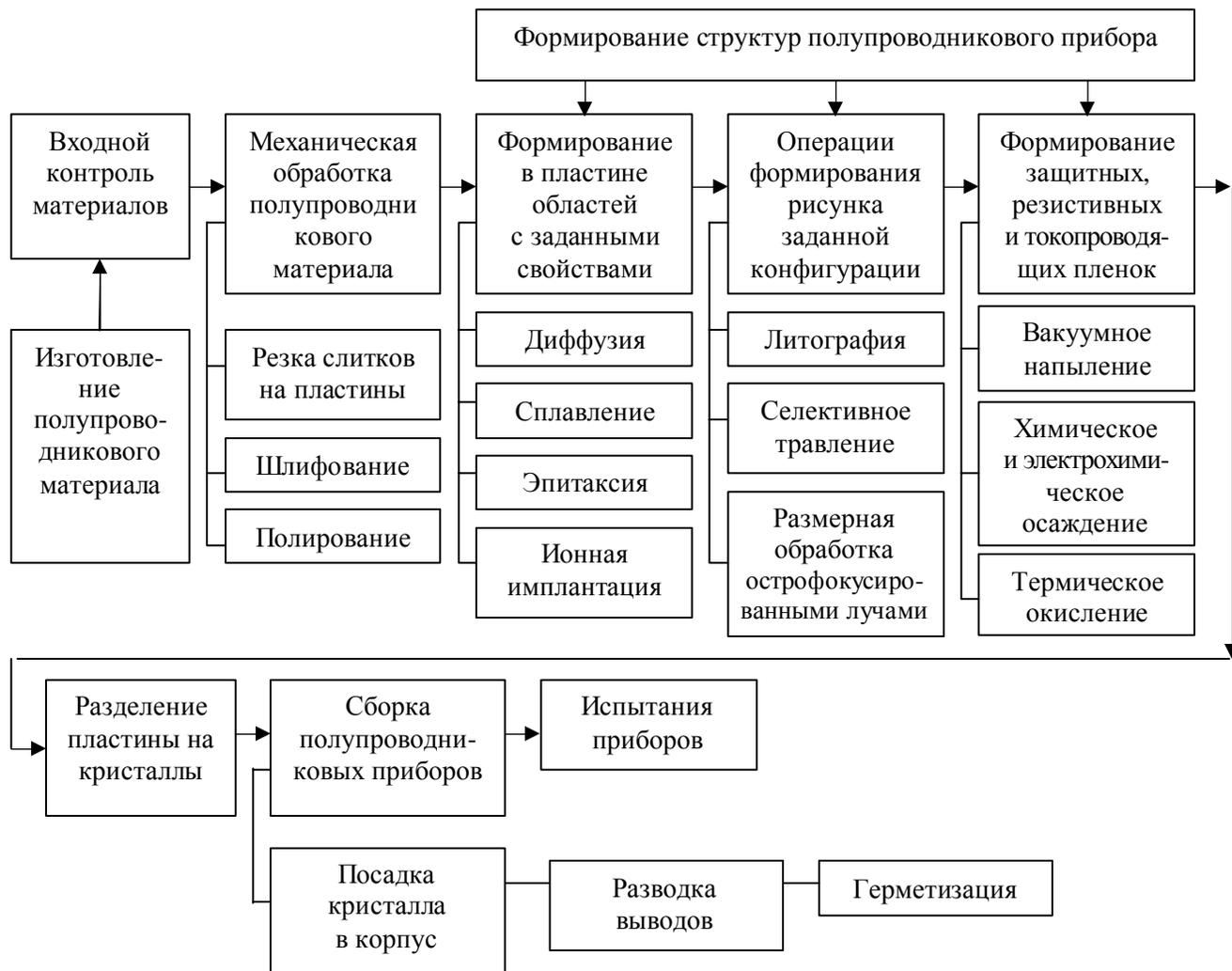
Рис. 24. Структурная схема процесса изготовления полупроводникового прибора
