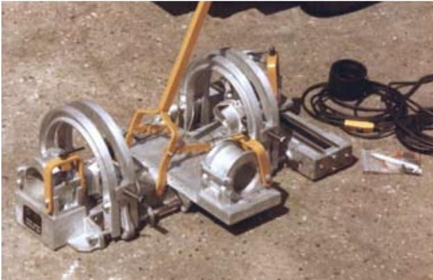
Рис. 3. Positioner для фиксации соединения при сварке тройников.
