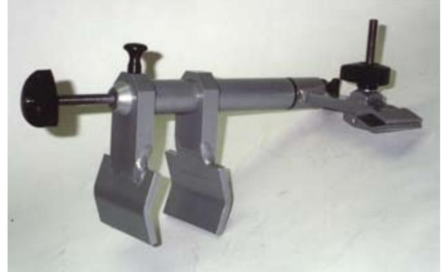
Рис. 6. Positioner для фиксации соединения при приварке труб к седельным отводам.
