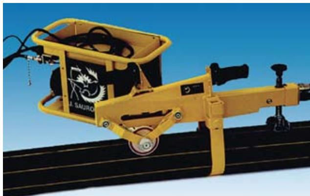
Рис. 11. Гидравлическое устройство Srocoplast для устранения остаточного изгиба концов труб.
