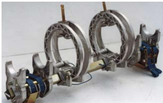
Рис. 9. Один из первых серийно выпускаемых позиционеров Posiplast 125 (1981 г., Saugon). Разработан для установки муфт с ЗН, фиксация труб обеспечивается вращением винтов в зажимах.
