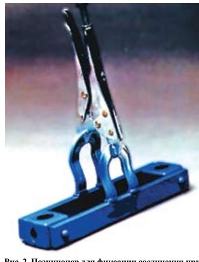
Рис. 2. Позиционер для фиксации соединения при сварке отводов на поворотах трубопровода.
