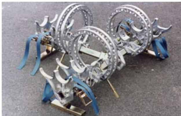
Рис. 12. Модель Posiplast 5000 дает возможность соединять трубы в линии. И под углами 45, 60 и 90 градусов устраняя при этом кривизну труб.
