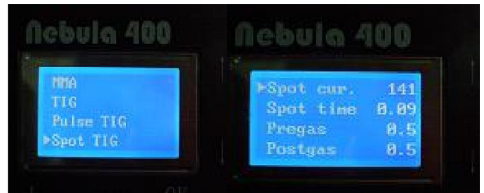
Меню режима ручной дуговой сварки неплавящимся электродом в среде инертных газов – TIG DC и TIG DC Spot
