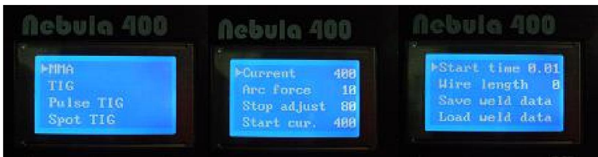
Меню режима ручной дуговой сварки покрытыми электродами – MMA
