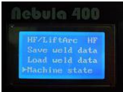
Меню режима ручной дуговой сварки неплавящимся электродом в среде инертных газов – TIG DC и TIG DC Spot
