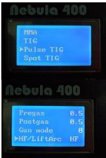
Меню режима ручной дуговой сварки неплавящимся электродом в среде инертных газов – TIG DC Pulse
