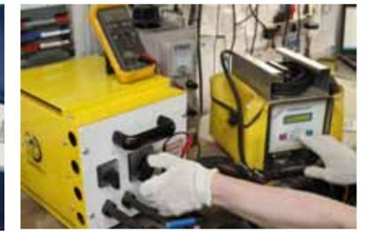
2 Проведение диагностики аппарата для сварки деталями с ЗН в ходе технического обслуживания
