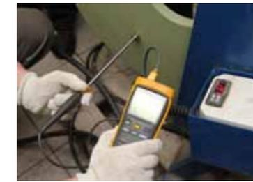
1 Измерение значения и распределения температуры по поверхности зеркала нагревателя во время технического обслуживания аппарата для стыковой сварки
