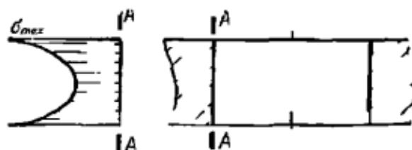
Рис. 19. Распределение напряжений по толщине материала в полосе, ослабленной отверстием
