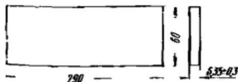
Рис. 50. Дополнительная ремонтная деталь верхней и нижней полок заднего конца продольной балки
