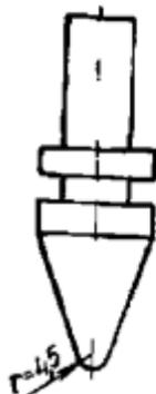
Рис. 16. Боек для упрочнения образцов пневматическим молотком
