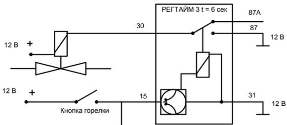
реле удержания реле продувки
