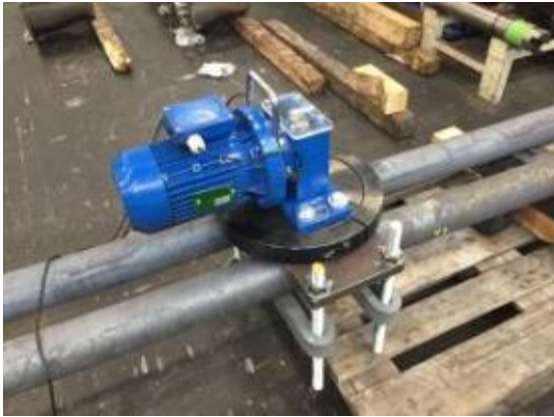
Снятие напряжений 4D 90°, поперечное направление, направление короткой оси.
