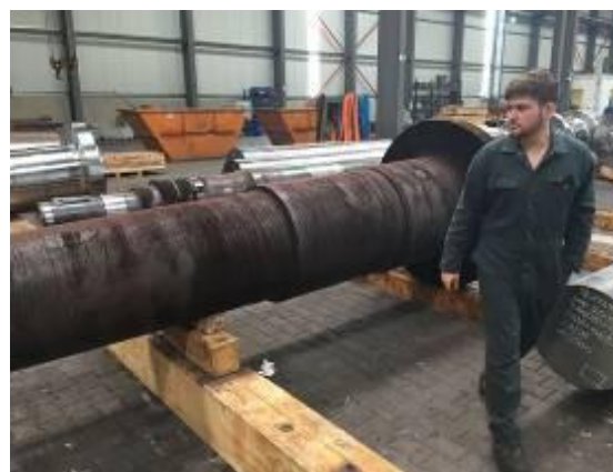
Отожженный вал с окалиной перед испытанием. Свен Видмер при подготовке WIAP® MEMV® эксперимента.
