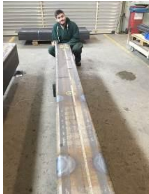
Деталь с обработкой пламенем в нескольких местах.
