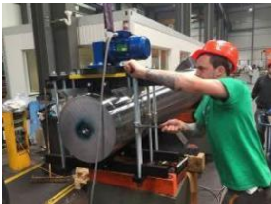
Разработанное AV и DV зажимное устройство; диаметром от 100 мм до 800 мм.
