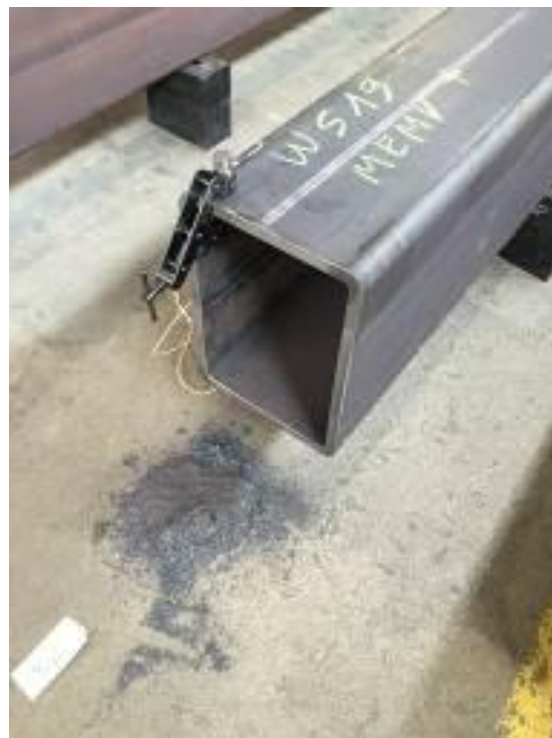
«При использовании метода WIAP® MEMV® с изделия снимается окалина».
