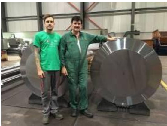
2 вала, у одного из которых напряжения были сняты вибрацией. Вместо того, чтоб у второго вала снять напряжения с WIAP® MEMV®, был взят отожженный вал. Слева Джим Питер Видмер; справа Ханс-Питер Видмер.
