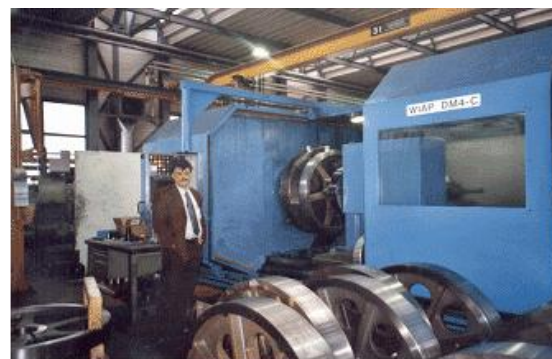
WIAP® DM4- токарный станок с ЧПУ, двойная X система направляющих, движущихся по отдельности
