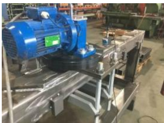
15000 Н V- возбудитель энергии может с помощью OV20 быть передан в деталь.
