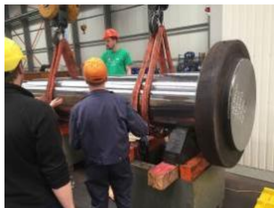
Подготавливаются валы для снятия напряжений с WIAP® MEMV®.
