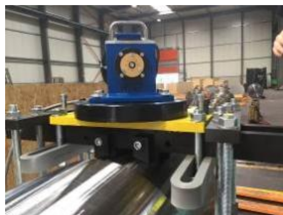
Поворотное устройство вид сбоку. Для будущей стандартизированной WIAP® MEMV® многоосевой системы вибрирования. Зажимное и поворотное устройство.
