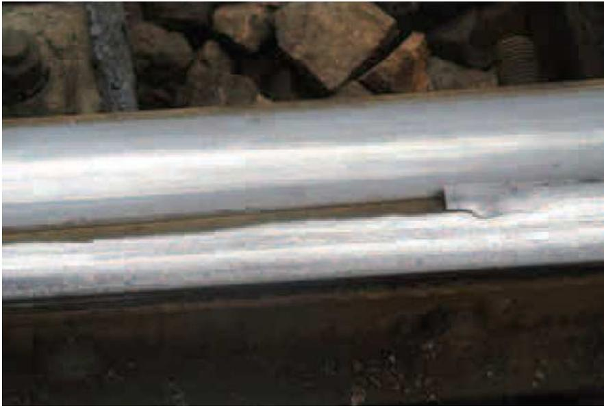
Рис. 5. Повреждение острьяка стрелочного перевода
