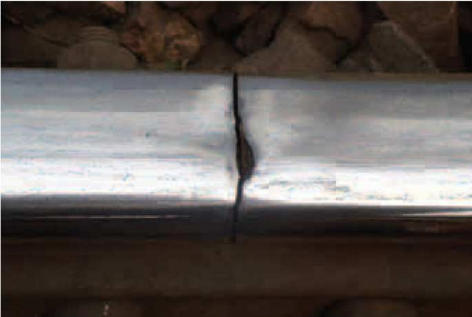
Рис. 2. Повреждение концов рельсов
