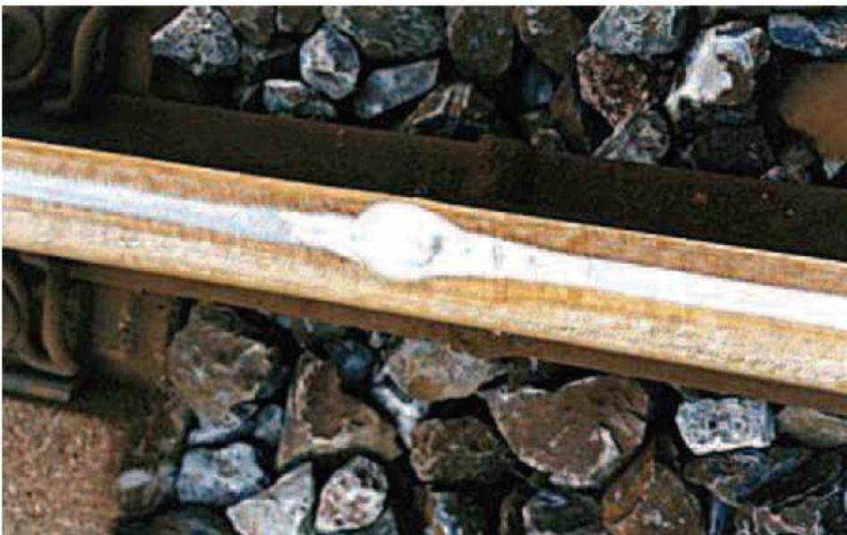
Рис. 3. Место пригорания колеса к поверхности рельса
