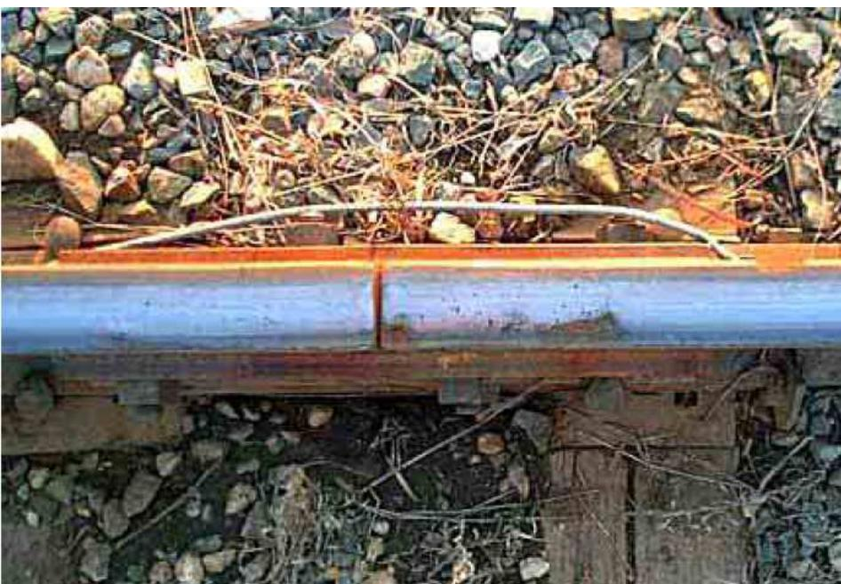
Рис.4. Дефект, образовавшийся в процессе прокатки рельса
