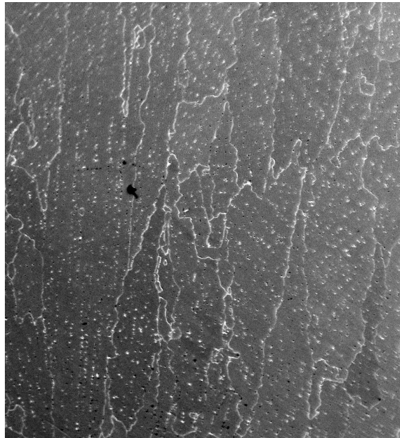
Рис. 1. Структура металла, наплавленного электродами НИИ-48Г; х 60
