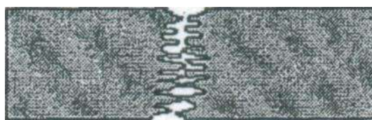
Рис. 8.2. Схема соприкосновения двух металлических поверхностей
