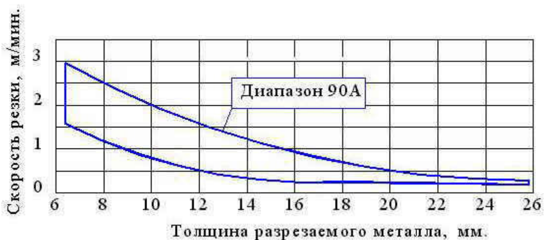
Рис. 4 Области оптимальных режимов воздушно-плазменной резки металлов для плазмотрона с воздушным охлаждением (ток 90А).
