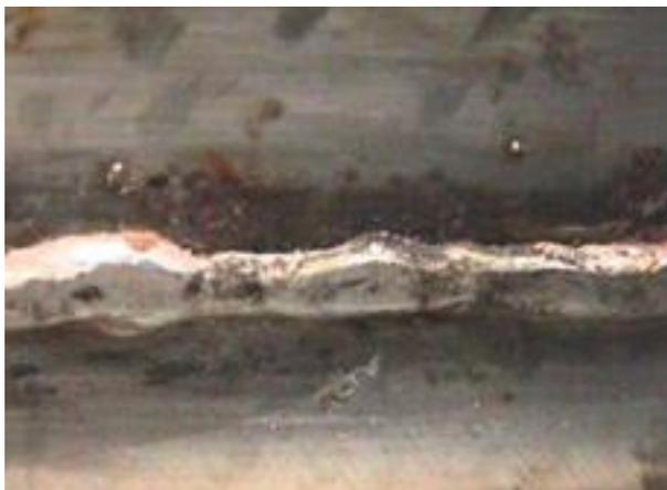
Рис. 2. Ножевая коррозия
