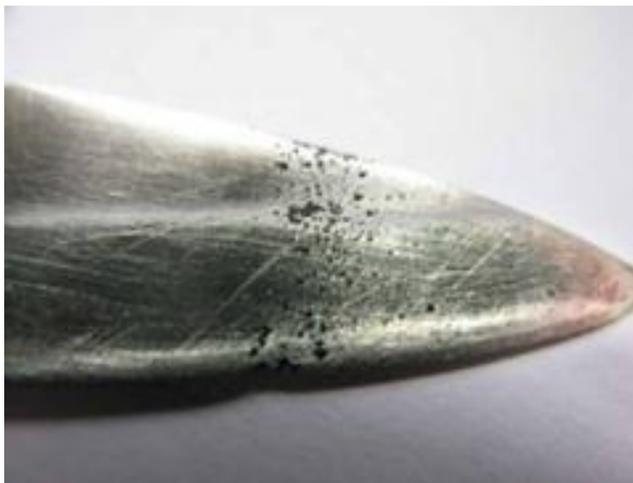
Рис. 3. Точечная коррозия
