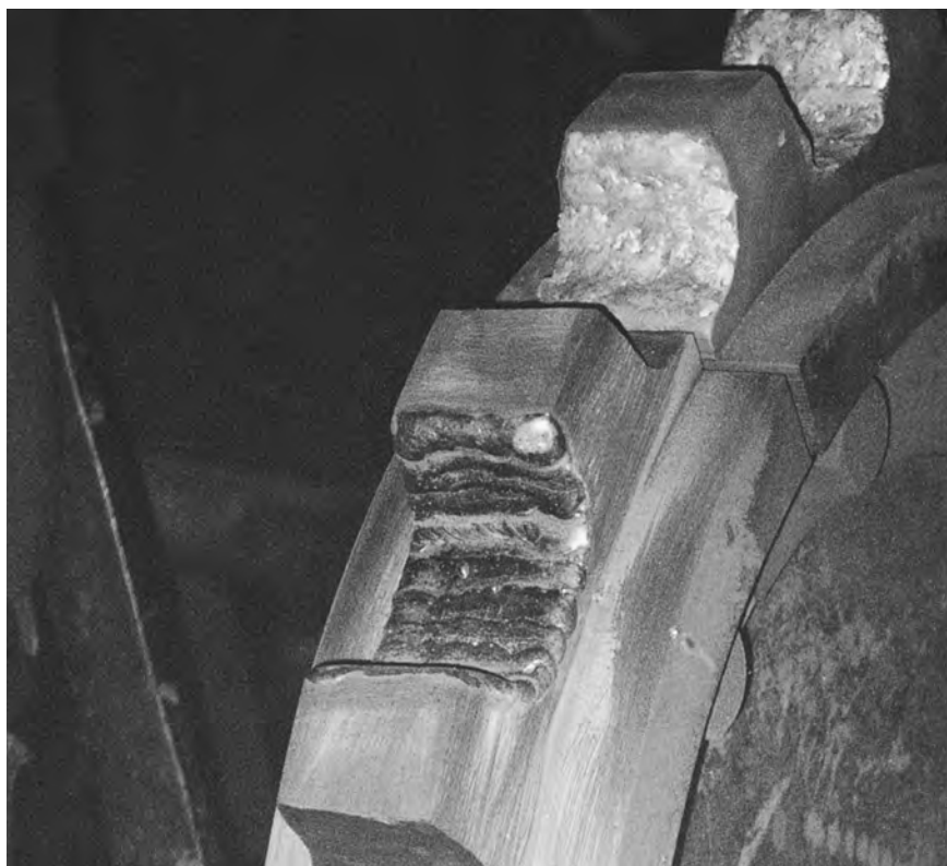
Зубчатое колесо, наплавленное электродами OK 83.28 .
