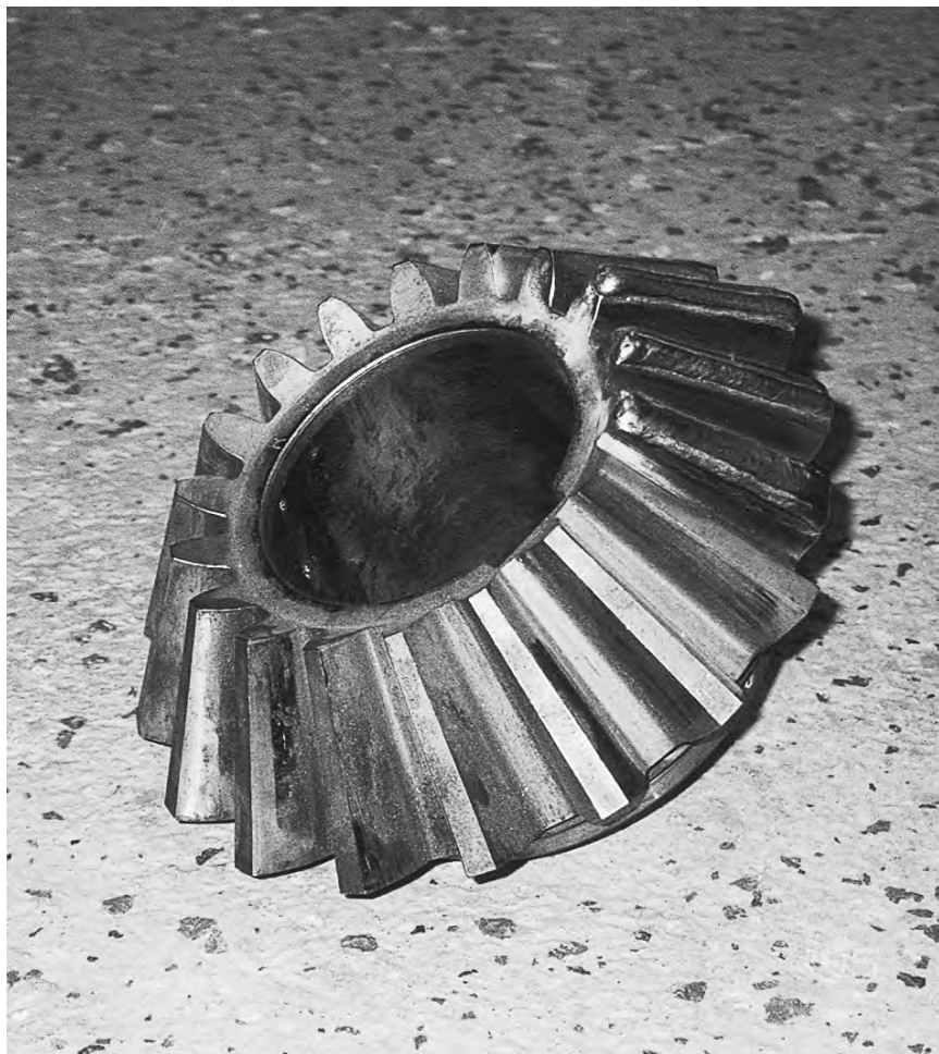
Коническая шестерня, наплавленная электродами ОК 68.82.
