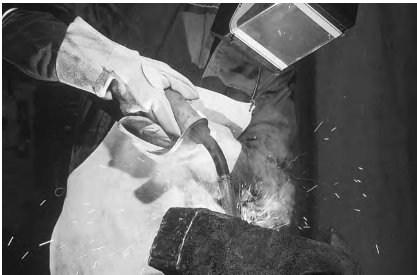
Восстановление рабочей поверхности бил с помощью проволоки OK Tubrodur 15.65 .
