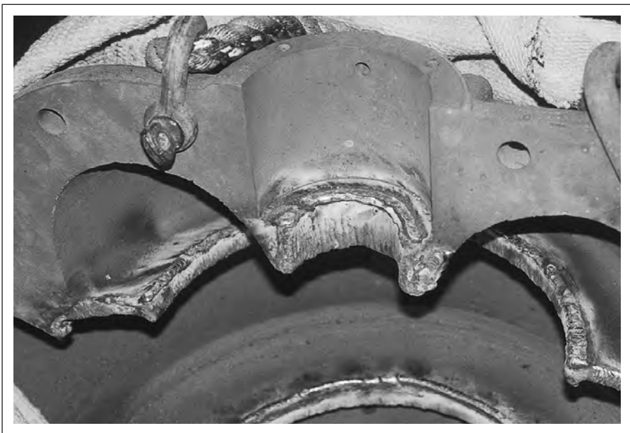
Корпус насоса, наплавленный электродами OK 94.25 .
