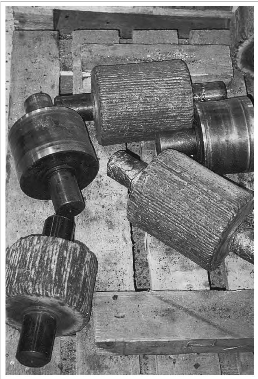
Поддерживающие ролики, наплавленные электродами ОК 84.52 и ОК 93.06.
