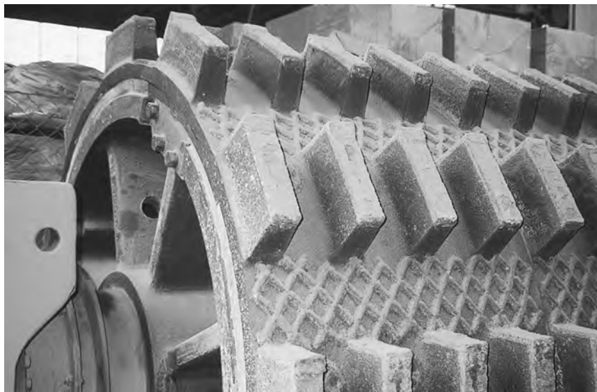
Изношенные зубья дробильного барабана, наплавленные электродами OK 86.20 и упрочненные электродами OK 84.78 и проволокой OK Tubrodur 14.70 .
