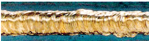
Шов, полученный при MSG пайке
