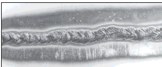
То же самое без использования защитного газа
