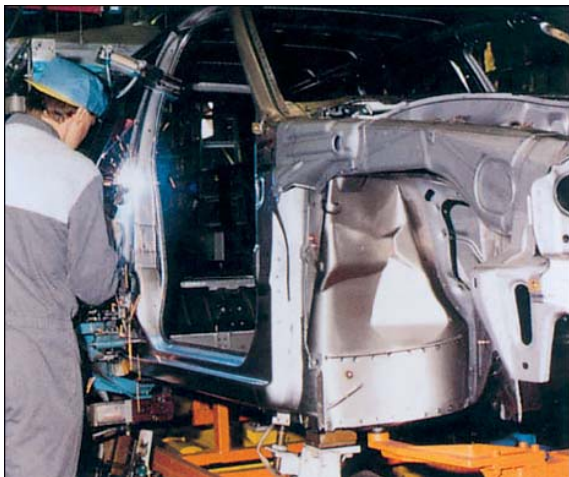
Сварка кузова автомашины методом MAGM
