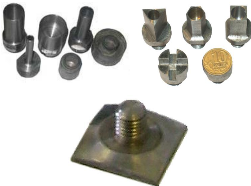
Рисунок 4.6 – Сменные рабочие инструменты для размерной обработки
