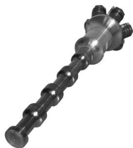
Рисунок 3.26 – Внешний вид ультразвуковой колебательной системы для проточной обработки жидких сред
