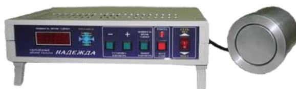
Рисунок 3.11 – Ультразвуковой технологический аппарат «Надежда»
