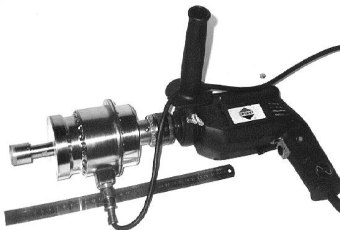
Рисунок 4.7 – Ультразвуковая колебательная система с вращением для размерной обработки
