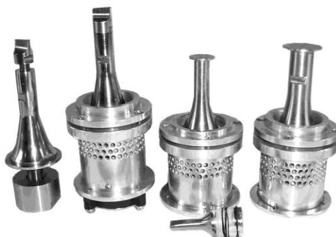
Рисунок 3.15 – Ультразвуковые колебательные системы для воздействия на жидкие среды
