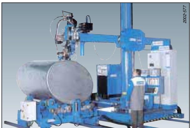
Эллиптическая сварка с использованием колонны и стрелы на ротаторе.
