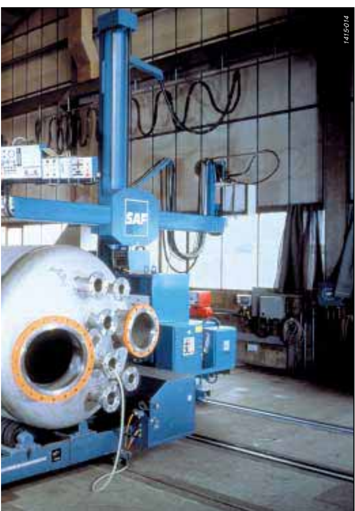
Эллиптическая сварка с использованием колонны и стрелы на ротаторе.
