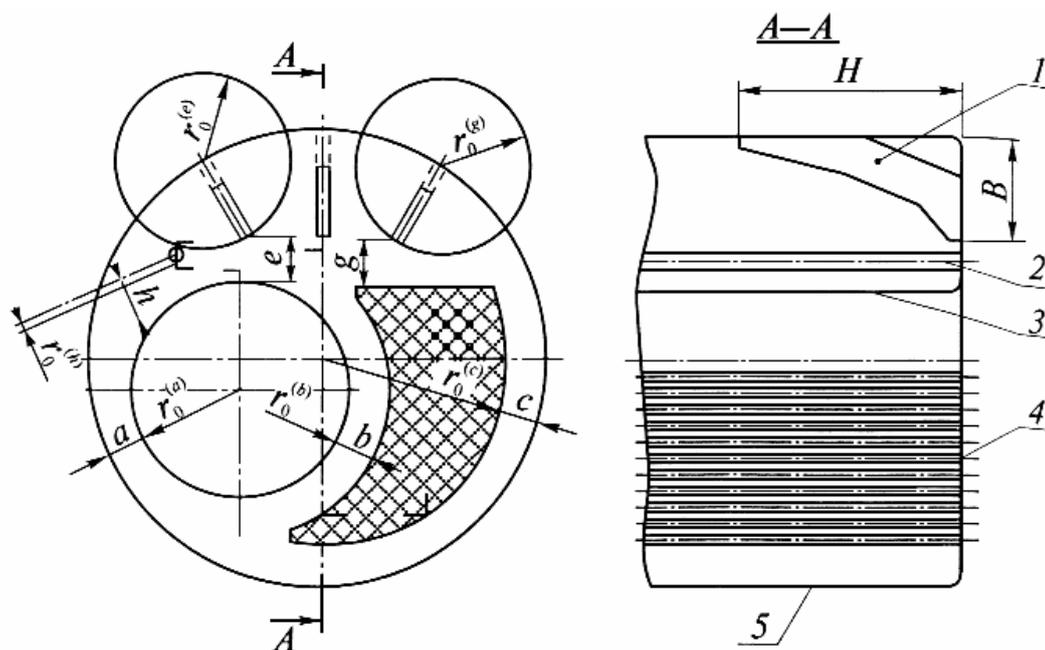
Рис.6.1: 1 - угловая связь; 2 - анкерная тяга; 3 - жаровая труба;
