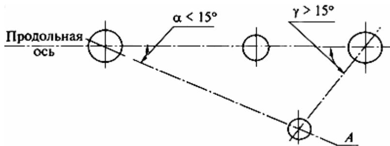
Отверстие  $A$  в направлении слева направо входит в ряд отверстий, так как угол  $\alpha < 15^\circ$ , и расчет допускается производить без учета угла как для продольного ряда.
