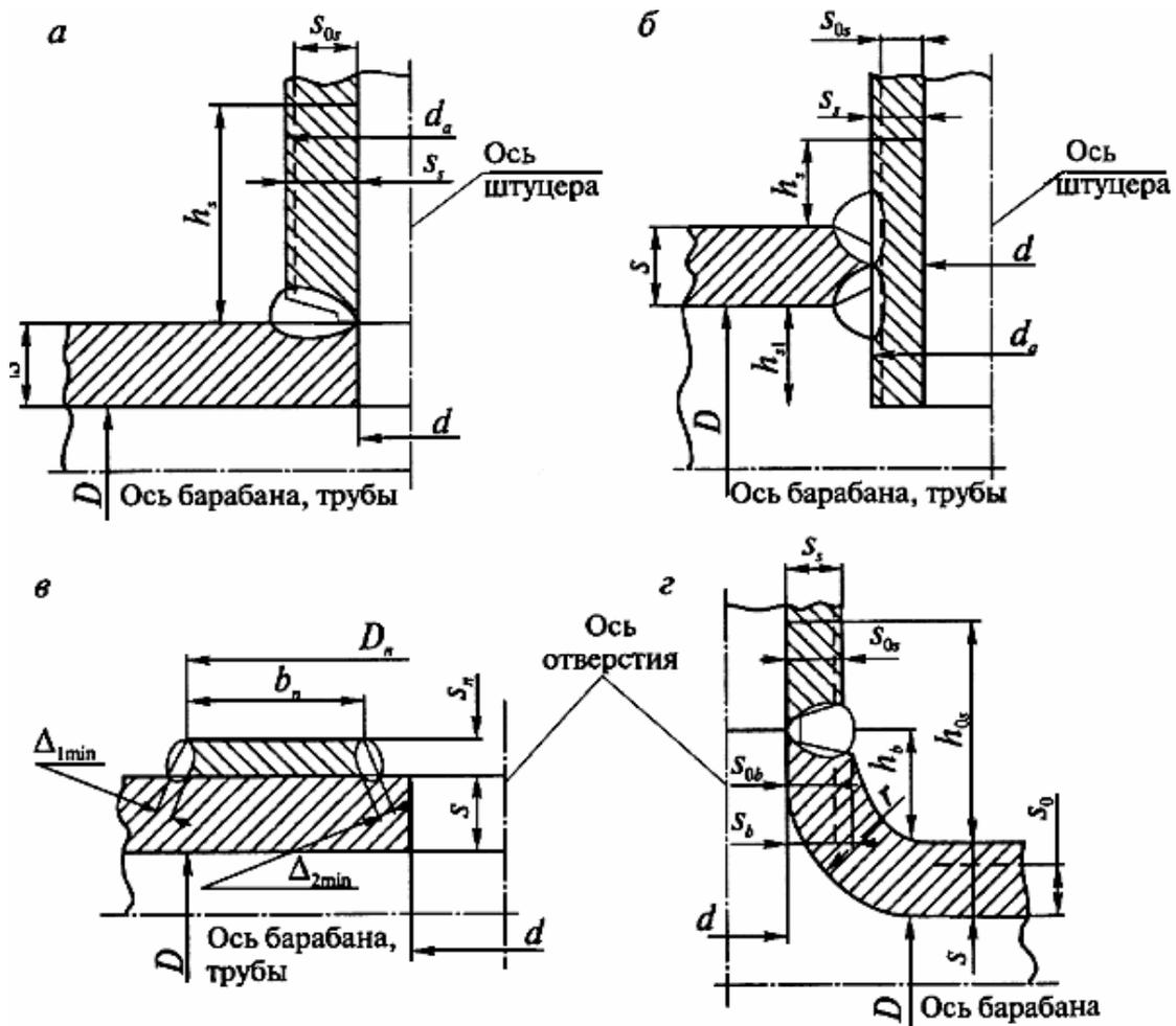
Рис.4.9. Укрепление отверстий:
