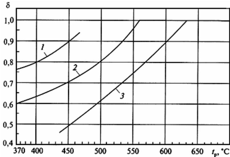
Рис.5.6. Коэффициент релаксации компенсационных напряжений:
