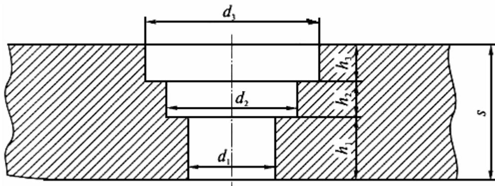
Рис.4.4. Отверстие с различными диаметрами по толщине стенки
