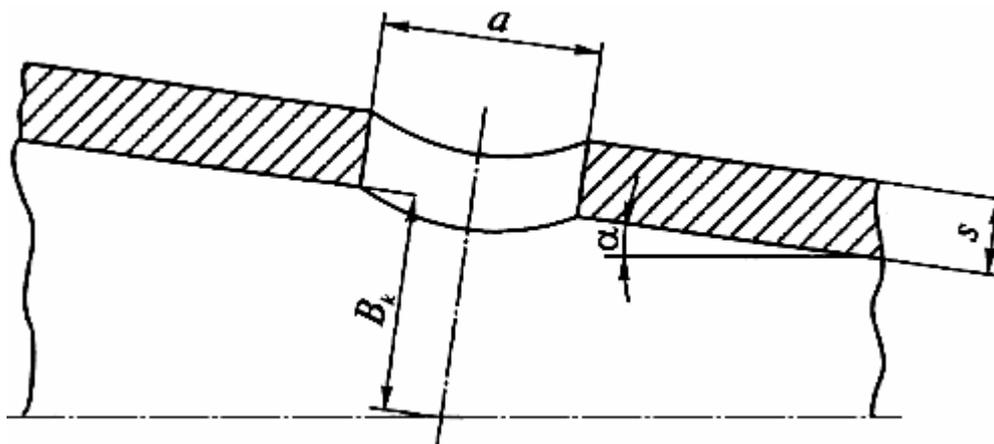
Рис.4.11. Коническая деталь
