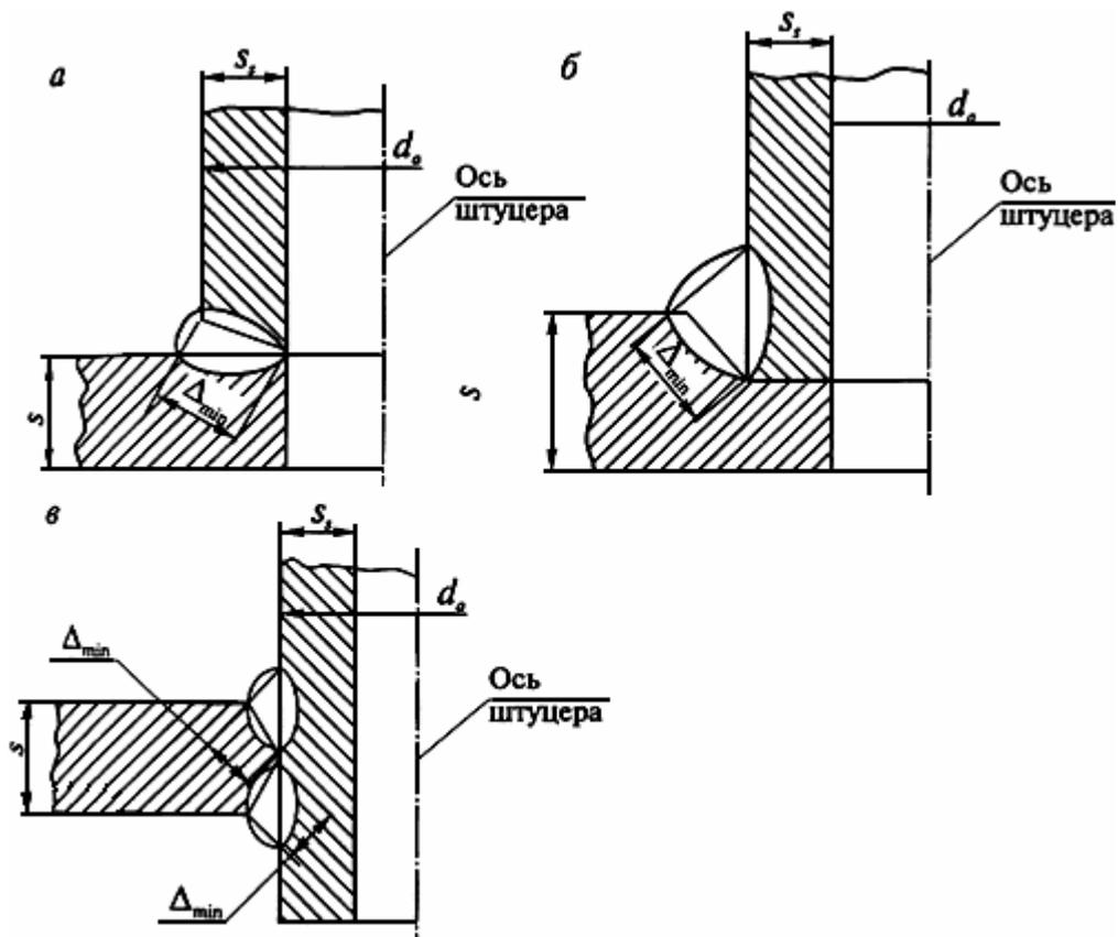
Рис.4.10. Расчетная высота углового шва ( $\Delta_{\min}$ ):
