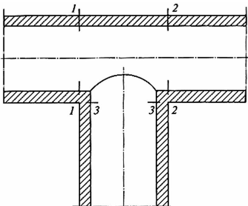
Рис.5.12. Расчетные сечения тройникового узла
