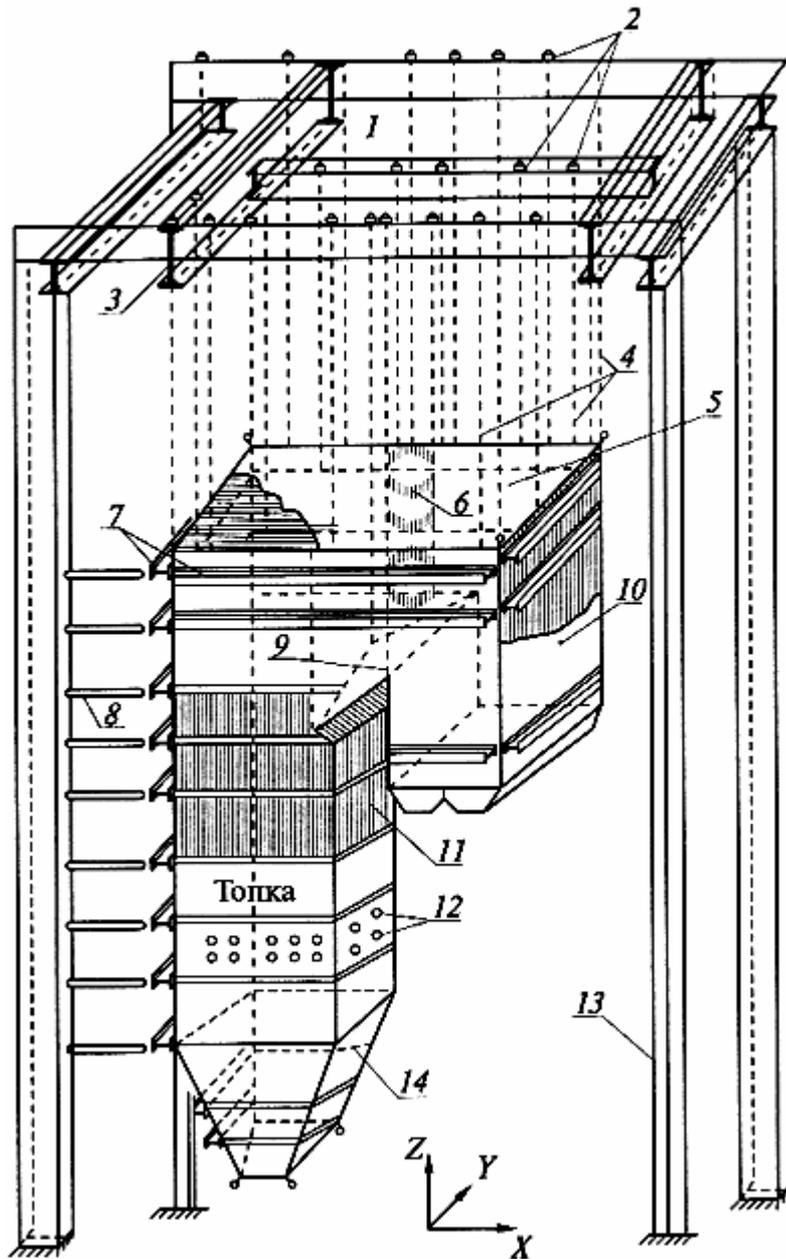
Рис.9.1: 1 - жесткий диск каркаса; 2 - тарельчатые пружины; 3 - хребтовая балка;
