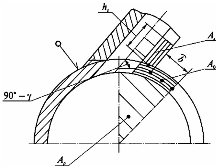
Рис.4.13. Схема детали с тангенциальным вводом штуцера
