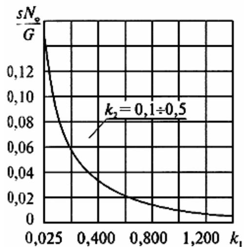
Рис.7.10. Номограммы для вычисления усилий  $N_z$ ,  $N_\phi$  в коллекторе при  $D_d/s = 14 \div 35$  и  $a < b$
