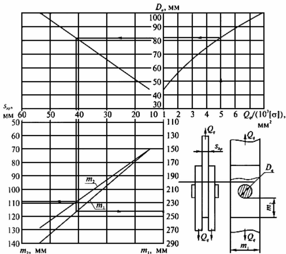
Рис.10.4. Номограмма для определения размеров элементов шарнирного соединения
