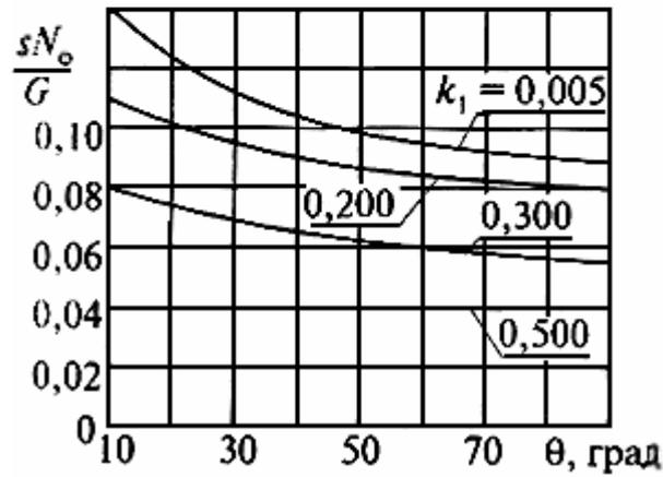
Рис.7.4. Номограммы для вычисления усилий  $N_z$ ,  $N_\phi$  в коллекторе при  $D_a/s = 9 \div 13$  и  $a > b$
