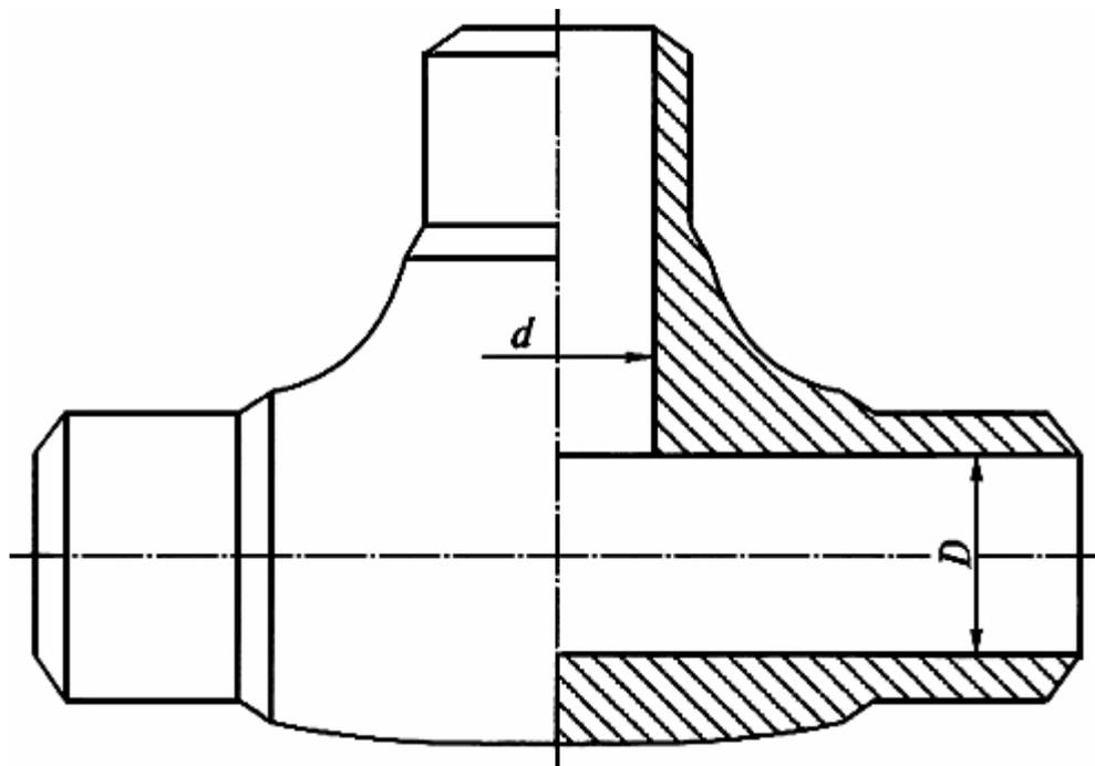
Рис.4.14. Схема ковального тройника
