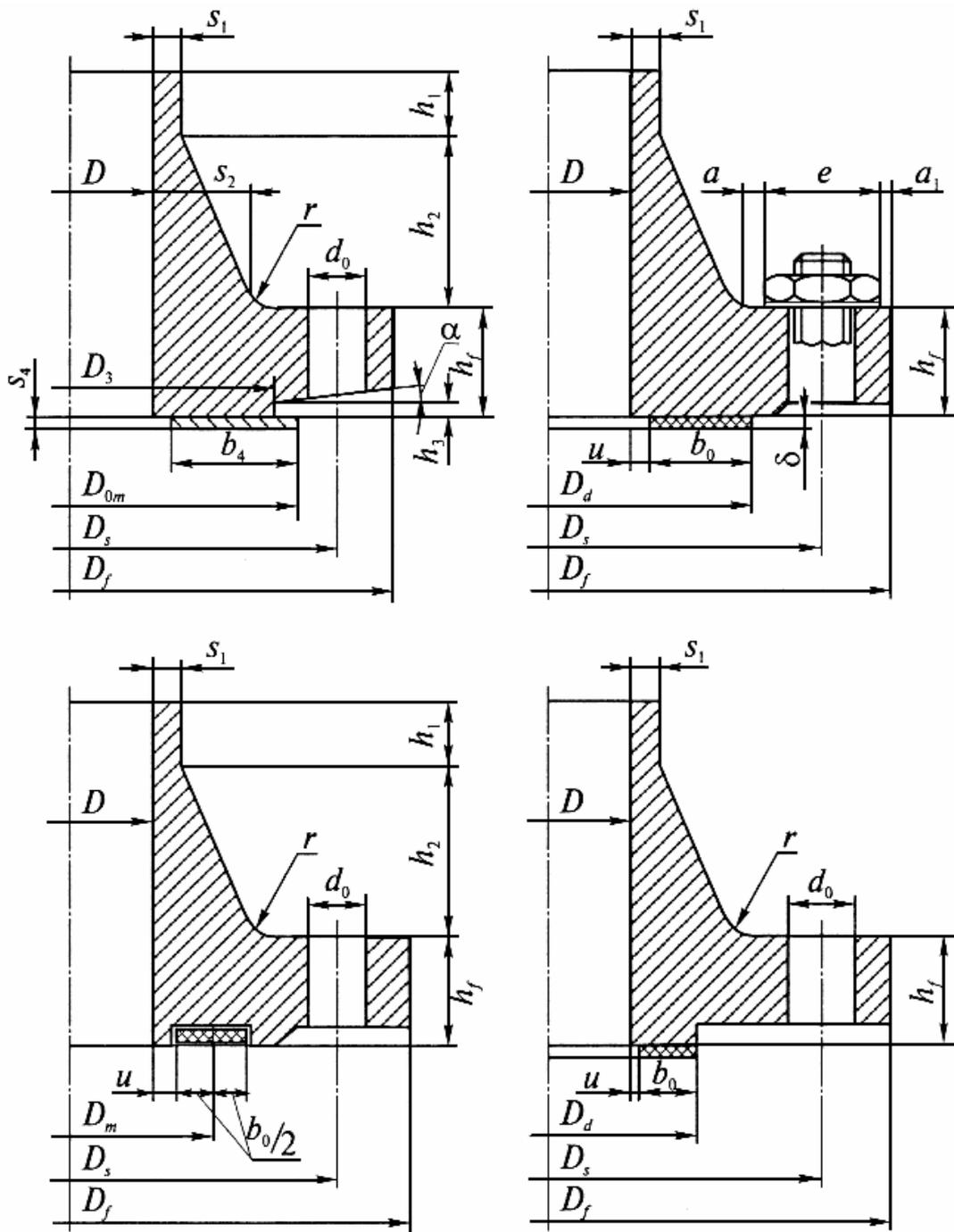
Рис.8.1. Фланцы с коническим переходом
