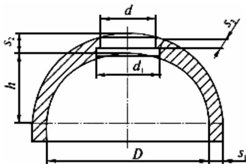
Рис.3.3. Лазерное отверстие в выпуклом днище переменной толщины
