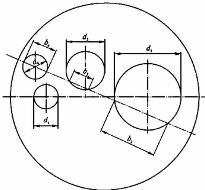
Рис.3.6. Выбор максимальной суммы диаметров отверстий и их хорд в диаметральной сечении днища
