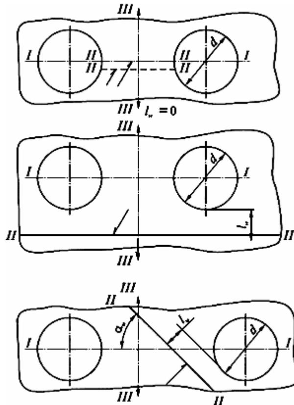
Рис.4.1: I - I - расчетное направление (для цилиндрической детали при расчете на внутреннее давление - продольная ось); II - II - средняя линия сварного соединения; III - III - направление расчетной нагрузки
