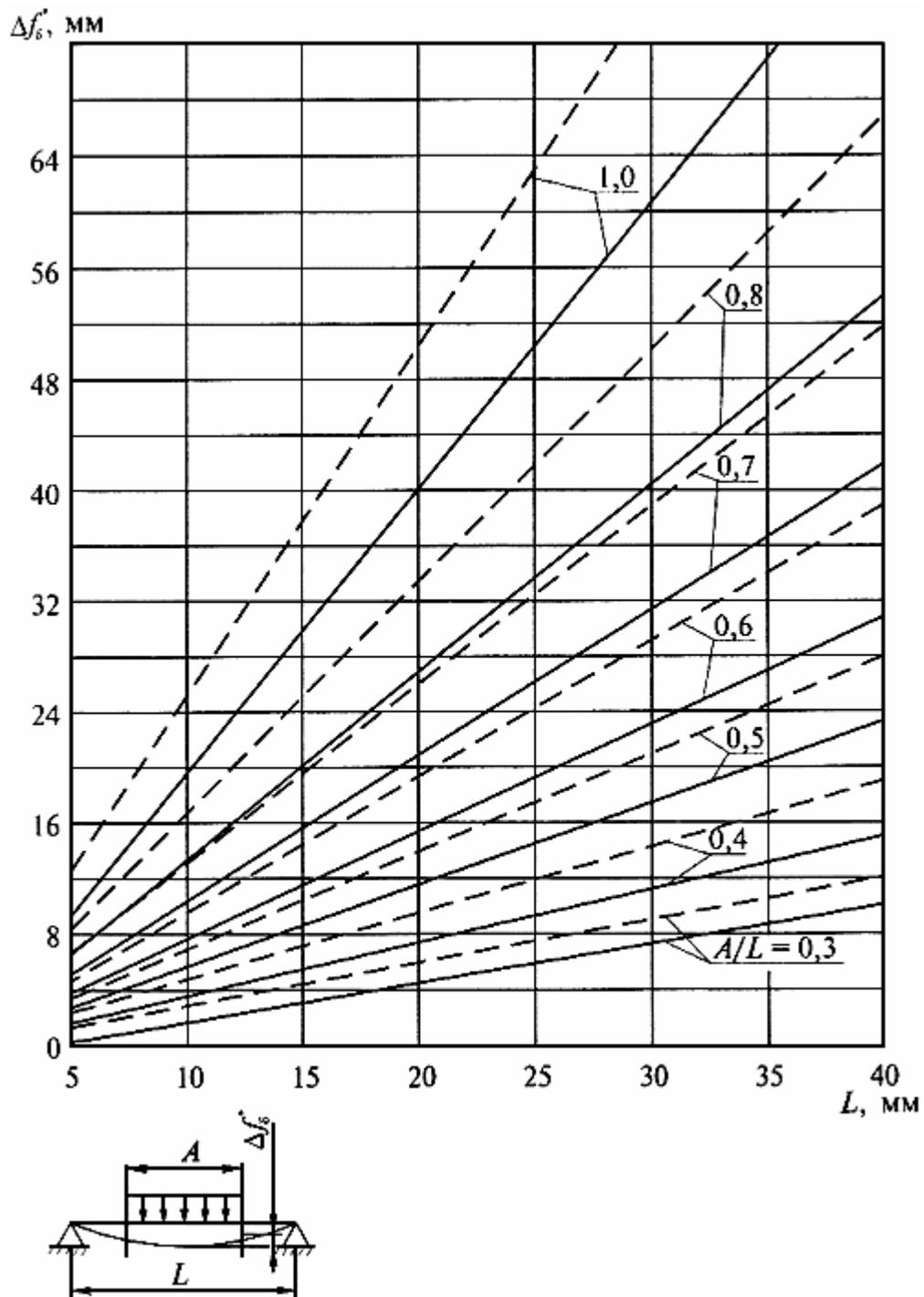
Рис.10.6. Номограмма для определения максимальной разности просянок пружин: ——— - при нормальных условиях эксплуатации ( $1/500$ );
