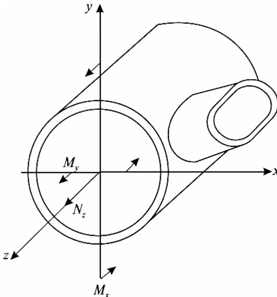
Рис.5.14. Силовые факторы в поперечном сечении тройникового узла
