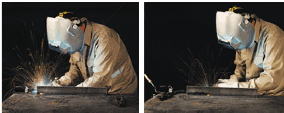
**Рис. 6 – Выполнение горизонтального углового шва при скорости подачи 4,4 м/мин. Защитный газ – 100% CO<sub>2</sub>. Слева – с использованием обычного источника для полуавтоматической сварки. Справа – с использованием источника STT.**
