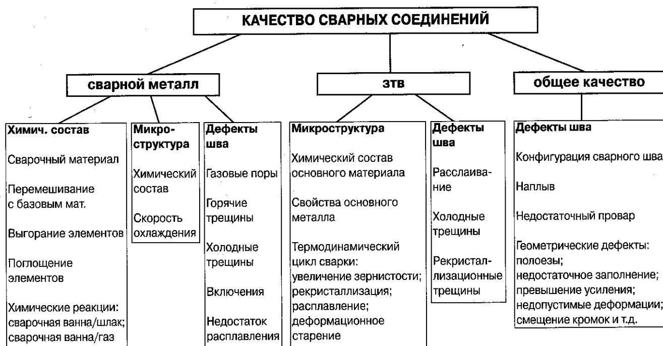
Рис. 1 Факторы, влияющие на качество сварных соединений.
