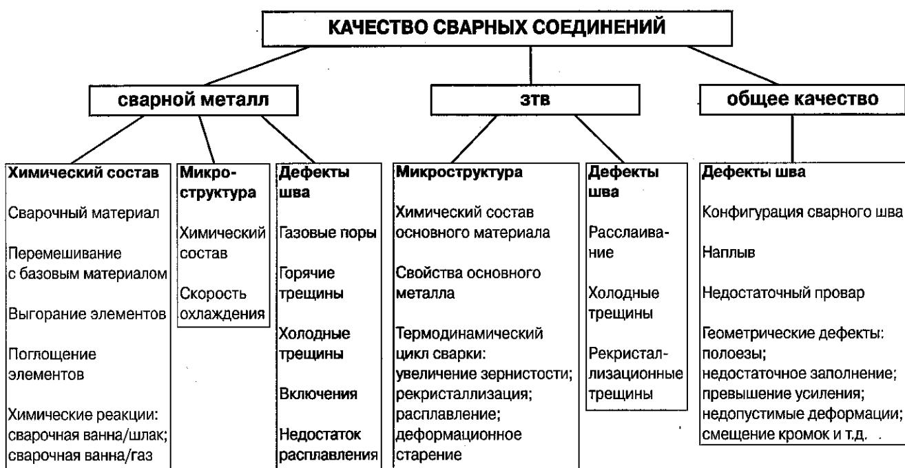
Рис. 4 Факторы, влияющие на качество сварных соединений.
