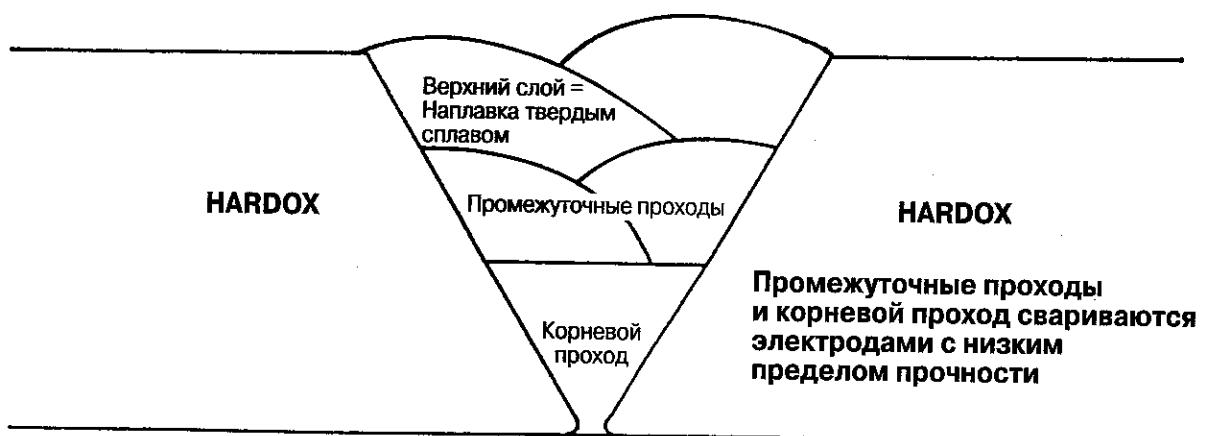
**Рис. 3в** Правильное сварное изделие из HARDOX-стали с наплавкой твердым сплавом последнего валика сварного шва (последнего прохода).
