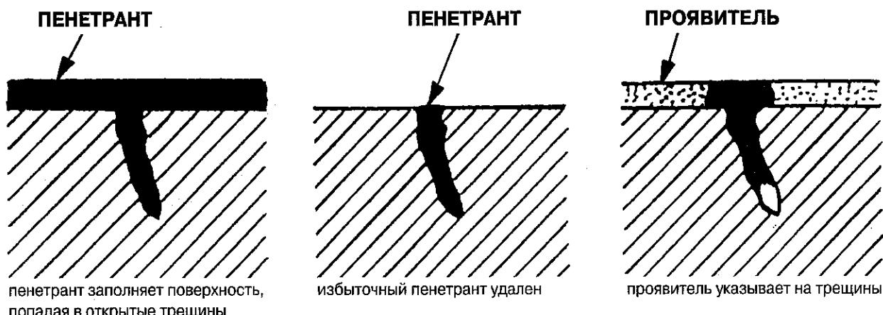
**Рис. 2.2 Капиллярная дефектоскопия**
