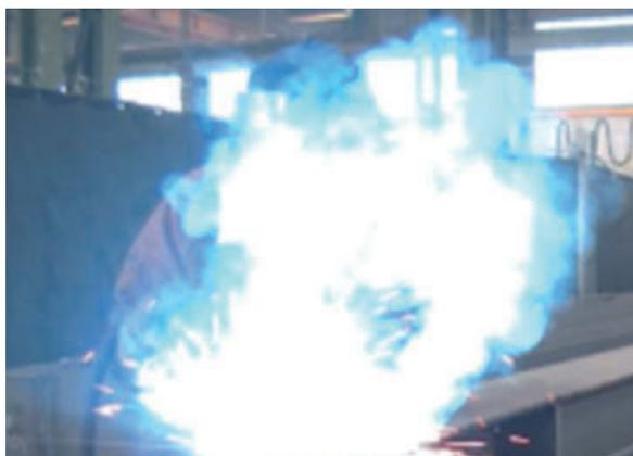
Раньше: образование большого количества сварочного дыма при использовании традиционных процессов сварки.
