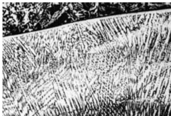
Рис.8 Наплавка электродами ESAB OK 92.26 выполнена на нелегированную сталь. В пограничной зона сплавления полностью отсутствуют дефекты типа трещин. Содержание Mn в наплавленном металле около 5% (увеличение 200х).
