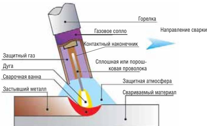
При MIG/MAG сварке (или GMAW) электрическая дуга возникает между свариваемым материалом и сварочной проволокой в среде защитного газа. Защитный газ может быть инертным (аргон Ar), активным (CO<sub>2</sub>) или их смесь (Ar + CO<sub>2</sub>). Проволока подается непрерывно механизмом подачи через горелку до сварочной ванны. При сварке этим методом можно применять сплошные (GMAW) и порошковые проволоки (FCAW-GS - сварка газозащитной порошковой проволокой).
