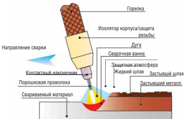
Сварка проволокой Innershield происходит без применения защитного газа. Innershield является самозащитной порошковой проволокой (метод FCAW-SS). Шихта, находящаяся в сердечнике проволоки, во время сварки выделяют газы и шлак, защищающие ванну и горячий затвердевший металл шва.
